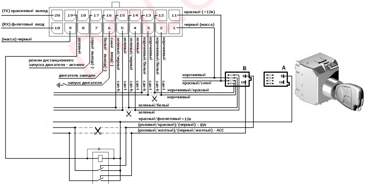
Схема подключения для кузовов: W166, (W463 2013->).
